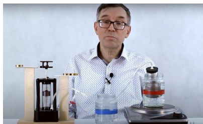
Рис.2. Рабочее тело имеет температуру нагревателя ( T=373K ), поршень находится в верхней точке
