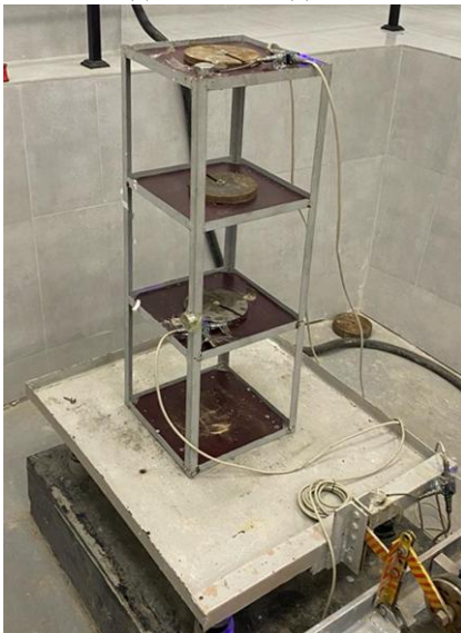
Рис. 1. Установленная модель на сейсмоплатформе
