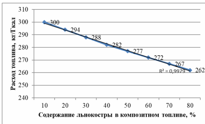
Рис. 1. Изменение удельного расхода топлива на единицу энергии при добавлении льнокостры к торфу
