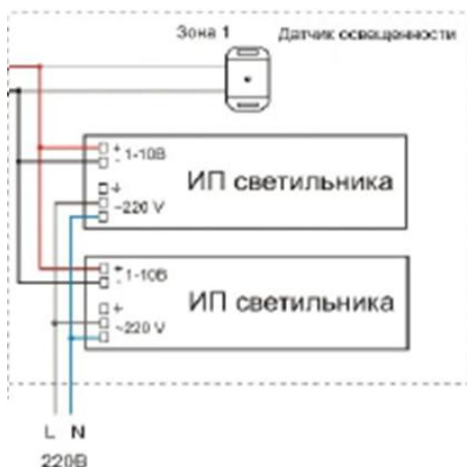
Рис.8 Подключение датчика постоянной освещенности к группе светильников.
